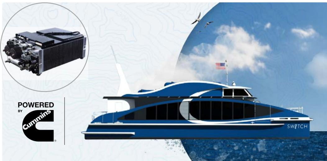
Avec un groupe motopropulseur conçu par Golden Gate Zero Emission Marine, le Sea Change est alimenté par une pile à combustible de 360 kW Cummins et peut atteindre des vitesses allant jusqu'à 22 nœuds.
