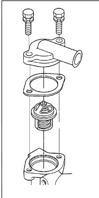
FIGURE 21. THERMOSTAT ET BOÎTIER TYPES
