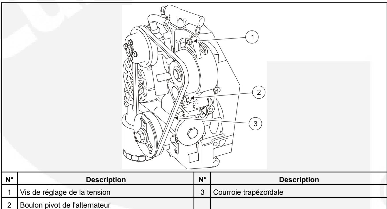
**FIGURE 23. RÉGLAGE DE LA TENSION DE LA COURROIE TRAPÉZOÏDALE**
