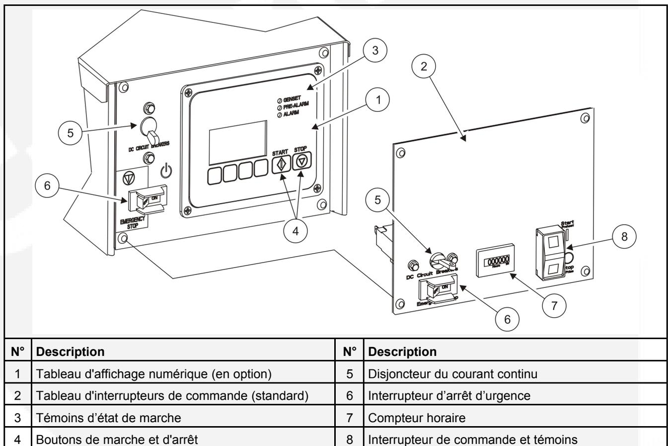
FIGURE 4. COMPOSANTES LOCALES DU PANNEAU DE CONTRÔLE
