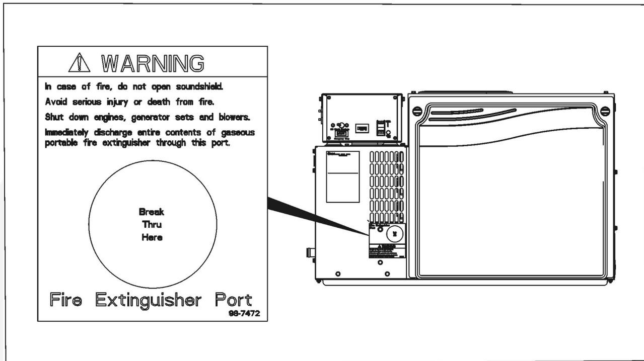
FIGURE 12. EMBLACEMENT DE L'ÉTIQUETTE DU PORTE EXTINCTEUR
