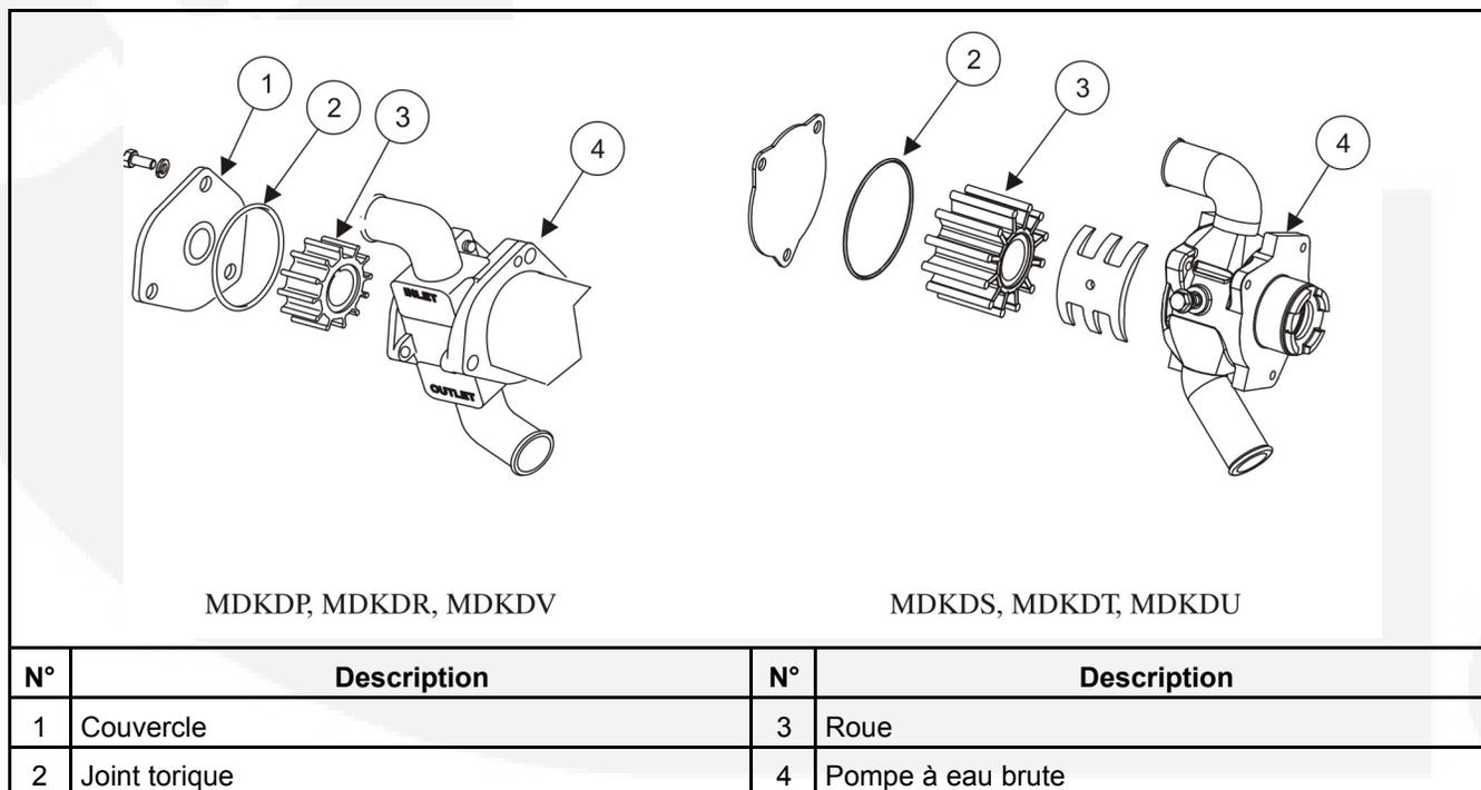
**FIGURE 22. REMPLACEMENT DU ROTOR DE LA POMPE À EAU BRUTE**
