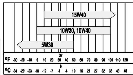
FIGURE 16. VISCOSITÉ DE L'HUILE CONTRE TEMPÉRATURE AMBIANTE
