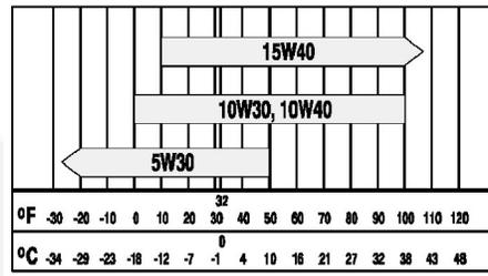
FIGURE 15. VISCOSITÉ DE L'HUILE CONTRE TEMPÉRATURE AMBIANTE
