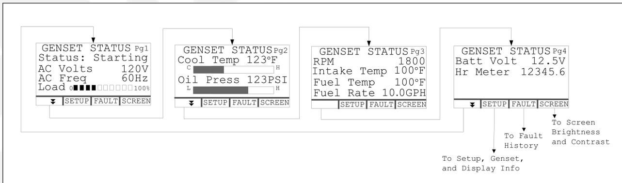
FIGURE 6. ÉCRANS D'ÉTAT DU GROUPE ÉLECTROGÈNE
