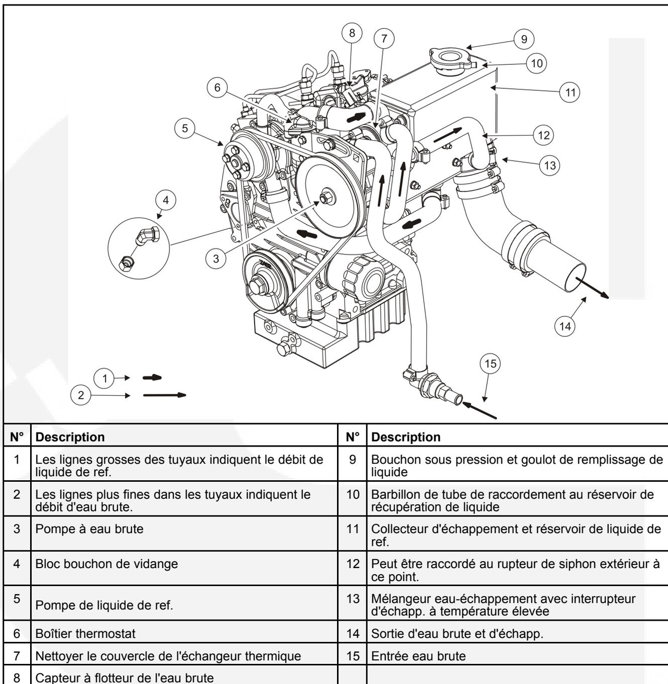
FIGURE 16. CIRCUIT DE REFROIDISSEMENT
