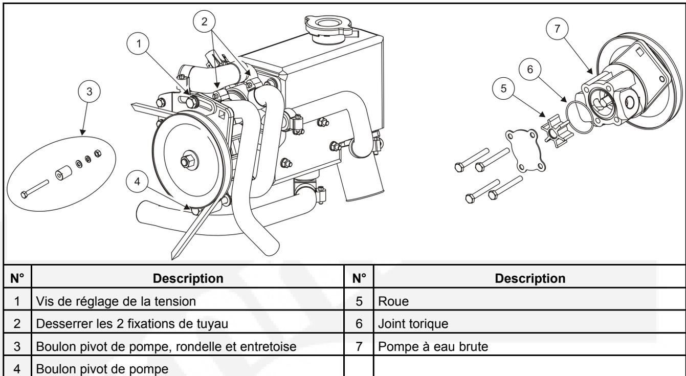
FIGURE 20. DÉPOSE DE LA POMPE À EAU BRUTE
