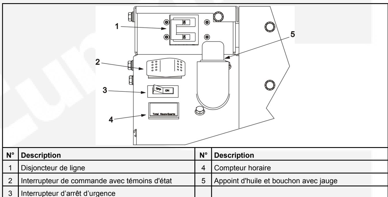
FIGURE 4. COMPOSANTES LOCALES DU PANNEAU DE CONTRÔLE
