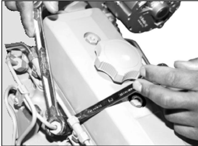
ABBILDUNG 24. ENTLÜFTEN DER EINSPRITZDÜSENLEITUNGEN
