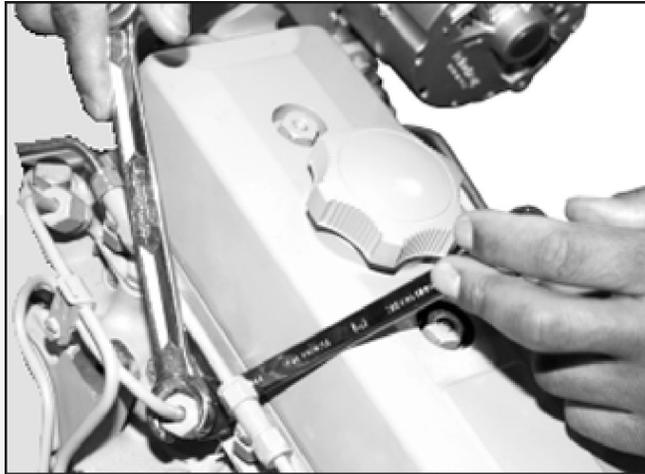
FIGURA 24. PURGA DE LÍNEAS DEL INYECTOR
